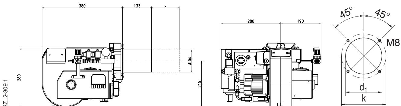
X= Расширение трубы горелки 100 ММ и 200 ММ
