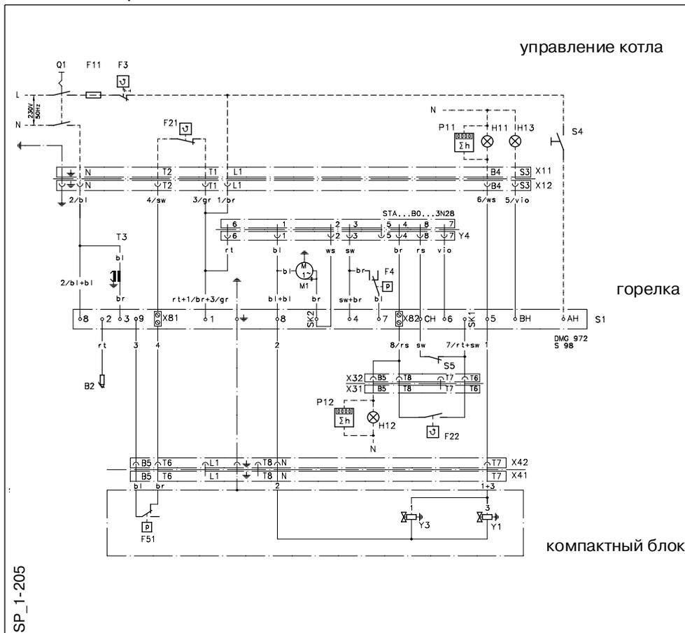
Схема электрических соединений RG30-M-L
