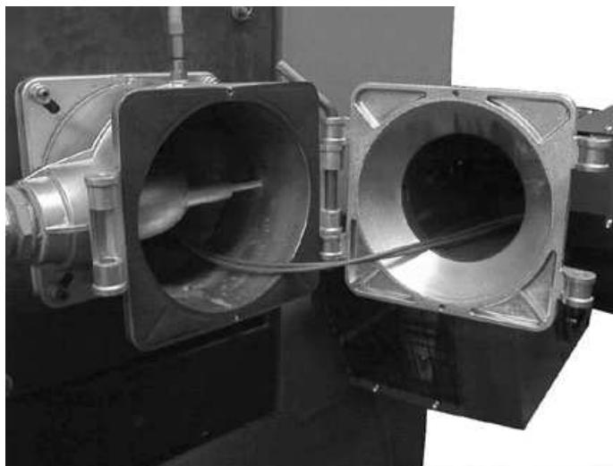
Вставьте корпус горелки в петлю газовой обоймы и закрепите его при помощи фиксирующего стержня. Горелка находится при этом в сервисном положении
