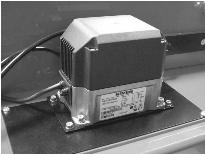
Сервопривод воздушной заслонки служит для регулирования её положения при двухступенчатом плавном и модулирующем режиме работы горелки. Управление приводом воздушной заслонки осуществляется через электронный микропроцессор топочного автомата
