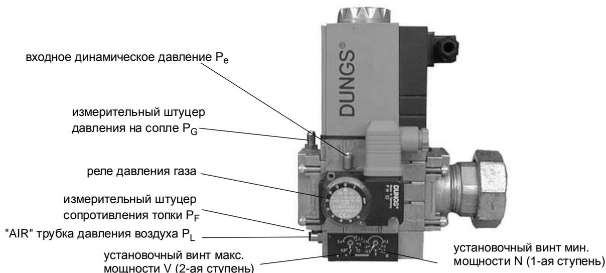
Выполнить соединение воздушной линии управления (синяя трубка) от штуцера «AIR» на компактном блоке к штуцеру измерения давления воздуха на газовой обойме. Трубка синего цвета является линией управления для компактного газового блока должна пролегать в свободном изгибе, без перегибов.
