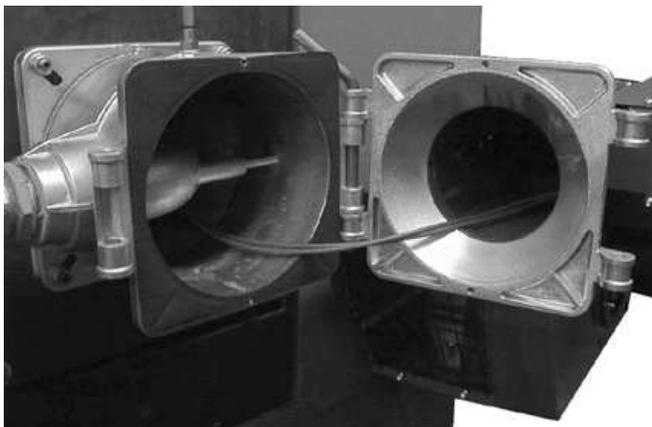
Вставьте корпус горелки в шарнир газовой обоймы и закрепите его при помощи крепёжного стержня. Горелка находится при этом в сервисном положении.
