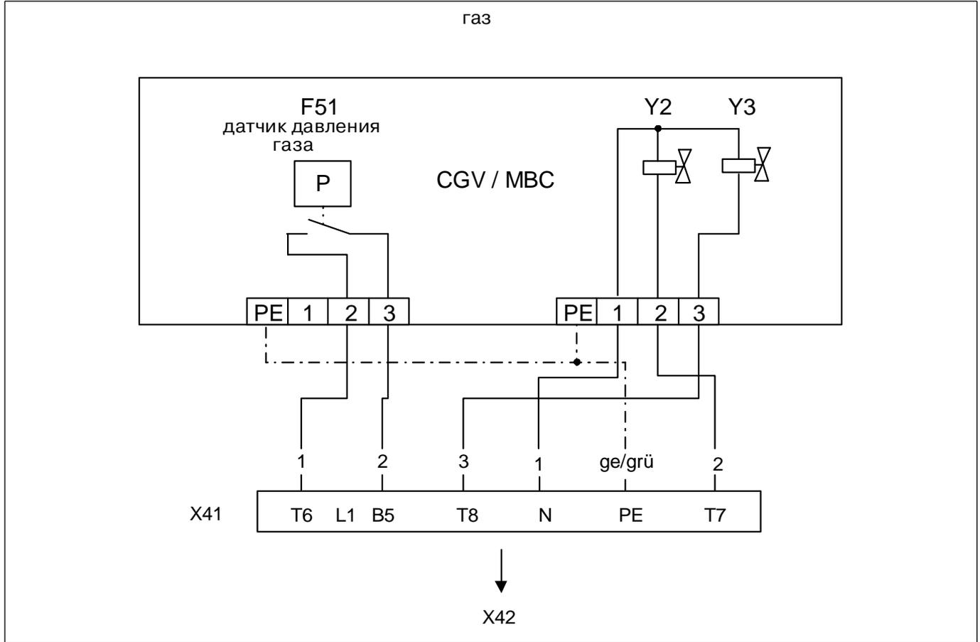
Электрическая схема стр. 4 (газовая арматура SKP)
