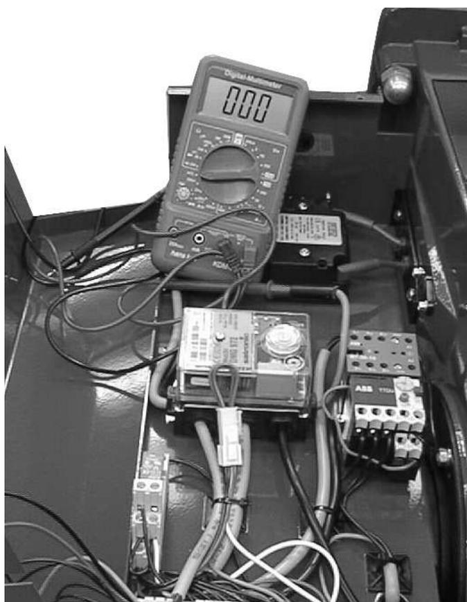
Если между горелкой и ионизационным электродом приложить переменное напряжение, то в результате воздействия пламени возникает постоянный ток. Ионизационный ток образует сигнал пламени, который после усиления передается на блок управления. Ложная индикация пламени невозможна, так как при коротком замыкании между чувствительным электродом и горелкой выпрямляющий эффект больше не действует.
