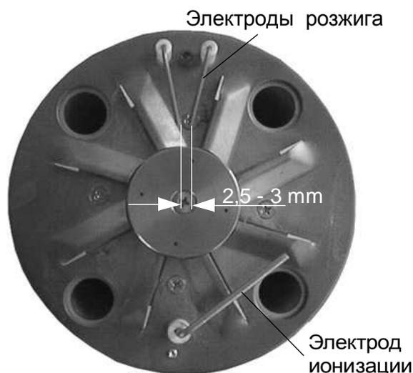
Электроды розжига предварительно устанавливаются на заводе. Указанные размеры служат для контроля.
