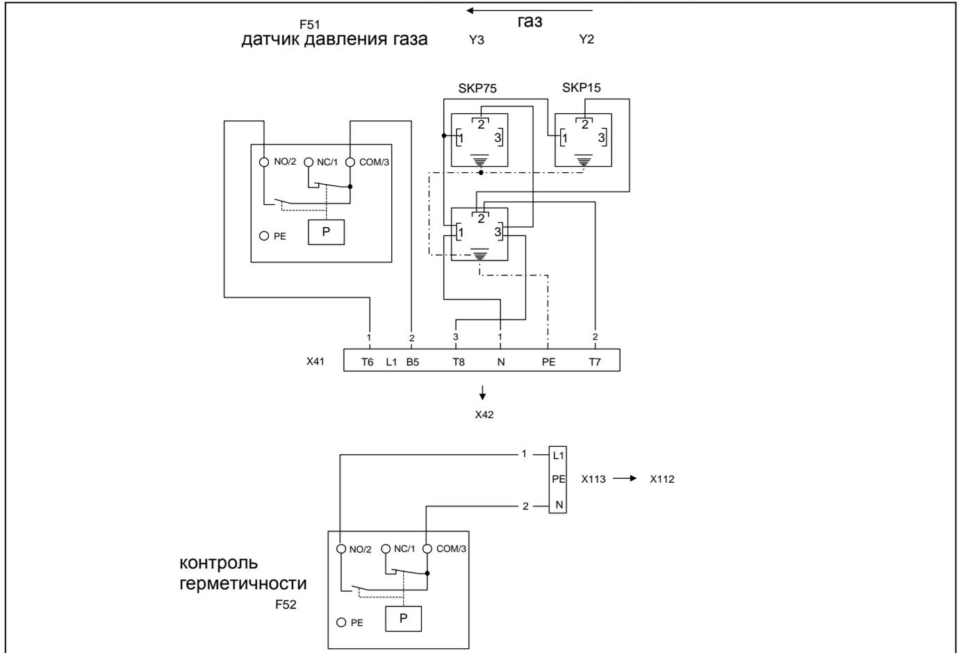
Электрическая схема для MG10/2-ZM-LN, стр. 5 (сервопривод)
