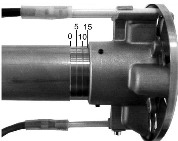
Позиция смесительного устройства зависит от потребной мощности горелки и устанавливается по таблице стр. 15.
