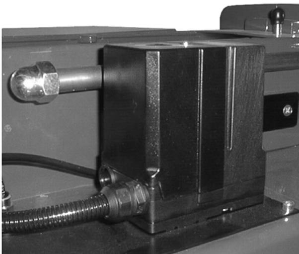
Сервопривод воздушной заслонки служит для установки воздушной заслонки у двухступенчатых и модулируемых горелок. Установки задаются через электронный блок управления или микропроцессором топочного автомата.
