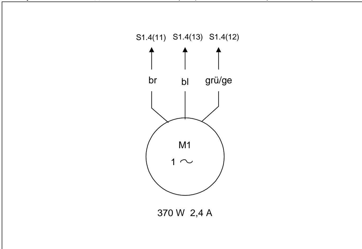
Электрическая схема для MG10/1-ZM-LN, стр.3 (газовая арматура CG)
