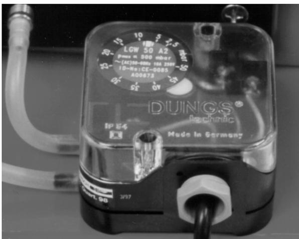
Реле контроля давления воздуха работает как дифференциальное реле давления и служит для контроля давления у горелок с наддувом. На заводе реле контроля давления воздуха предварительно установлено
