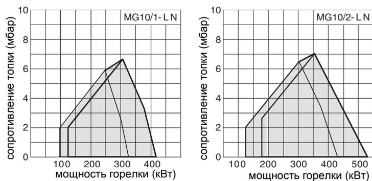
Рабочие зоны согласно DIN EN 676. Рабочие зоны действительны для окружающей температуры 15°C и 1013 мбар атмосферного давления.
