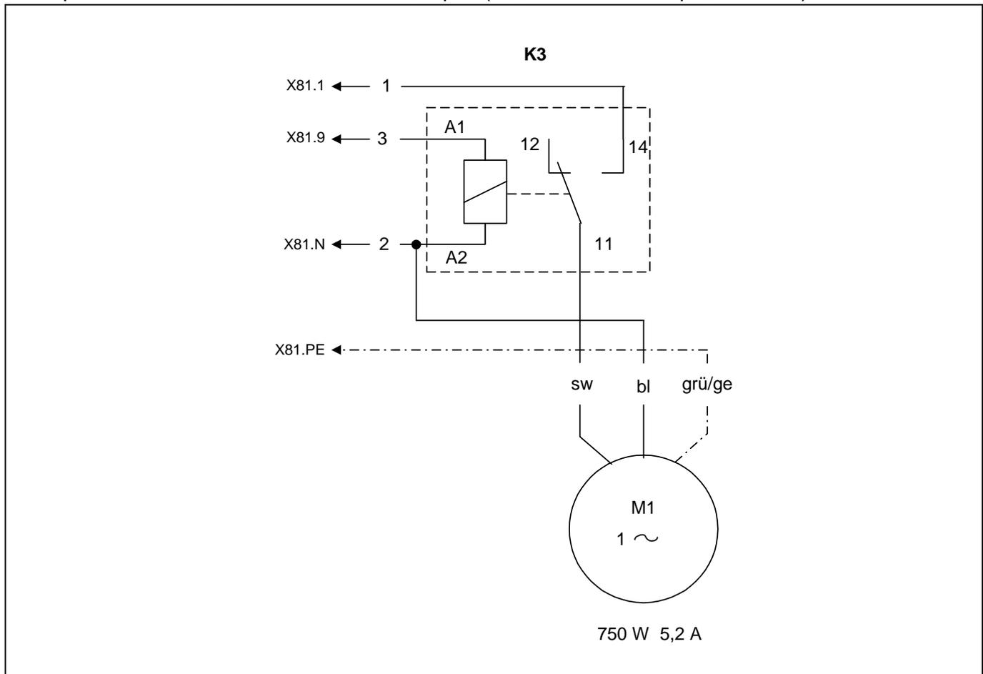
Электрическая схема для MG10/2-ZM-LN, стр. 3 (газовая арматура CG)
