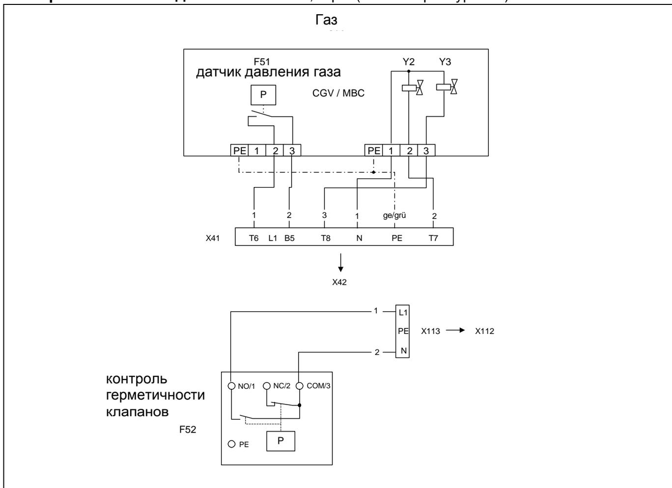
Электрическая схема для MG10/1-ZM-LN, стр. 4 (газовая арматура SKP)
