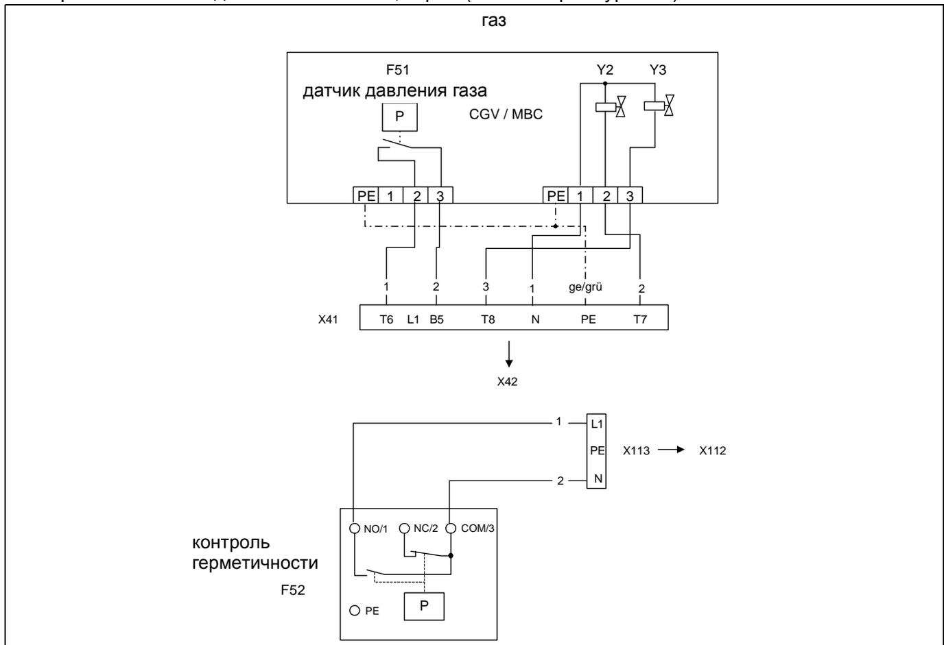
Электрическая схема для MG10/2-ZM-LN, стр. 4 (газовая арматура SKP)
