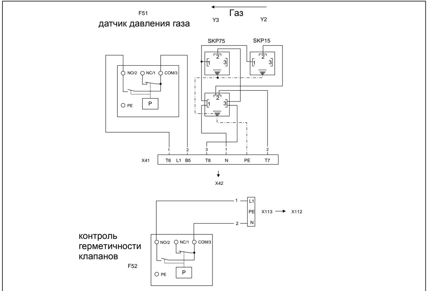
Электрическая схема для MG10/1-ZM-LN, стр. 5 (Сервопривод)
