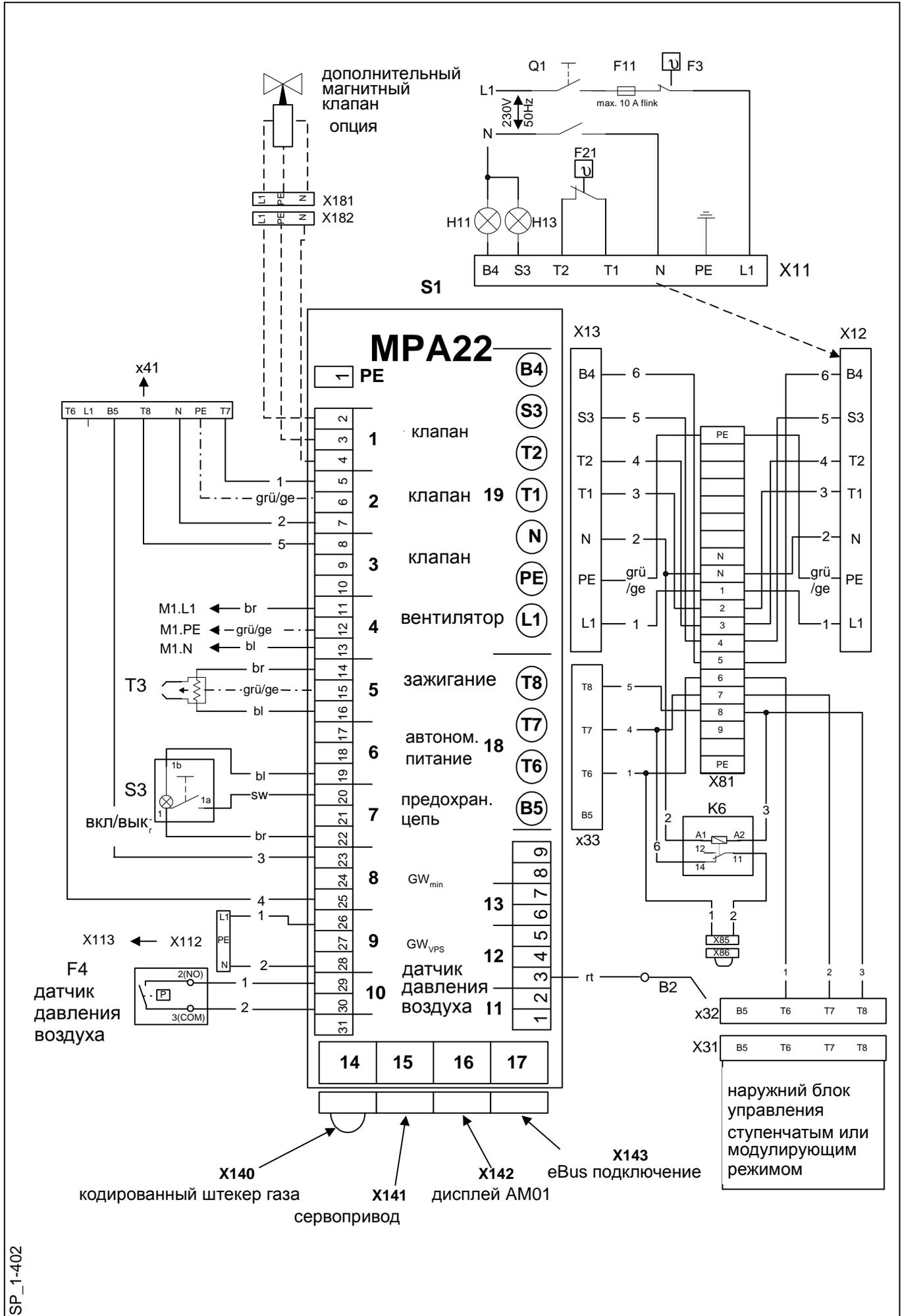
Электрическая схема для MG10/1-ZM-LN, стр. 2 (подключение электродвигателя)
