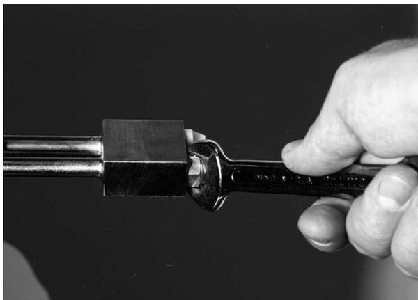
Выбранные форсунки ввинтить при помощи шестигранного ключа (SW16). Вильчатый гаечный ключ следует использовать как к контропору. Затем вплотную снова насаживается подпорный диск и затягивается до упора.
