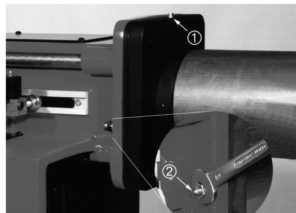
**Конструкция котлов с очень глубоко посаженной передней панелью или дверцей или же котлы с реверсивным пламенем требуют соответствующего удлинения смесительного устройства. Это смесительное устройство, если жидкотопливная горелка была заказана с удлинённым смесительным устройством, уже смонтировано.**
