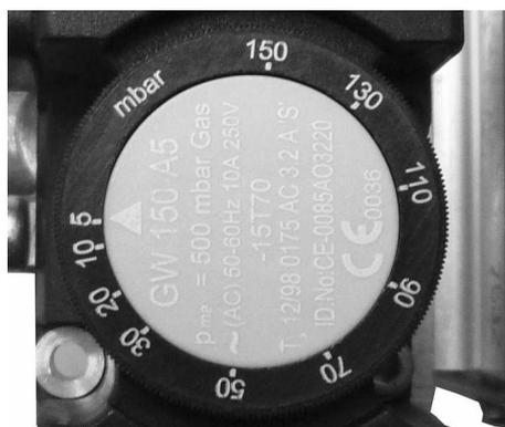
Установка датчика давления газа на мин. значение (5 мбар у MBC65 1/2")
