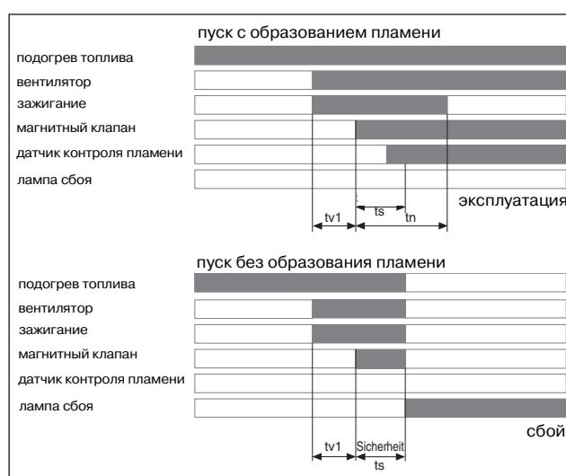
ts - контрольно-предохранительный период
