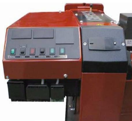
При проведении работ по подключению и демонтажу электрических частей перевести главный выключатель в положение «Выкл» и удалить предохранитель.
